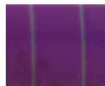
Φ/Β κυψελίδα του τύπου ITO/ a-Si:H/Al/πλαστικό υπόστρωμα
